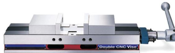
Após a remoção da castanha central, a morσα tem função de auto centragem.
